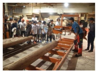
ベンチを作るために、間伐材の原木を角材や板材に加工していきます。オレンジ色の製材機を稼働させて、丸太をスライス状に切っていきます。
